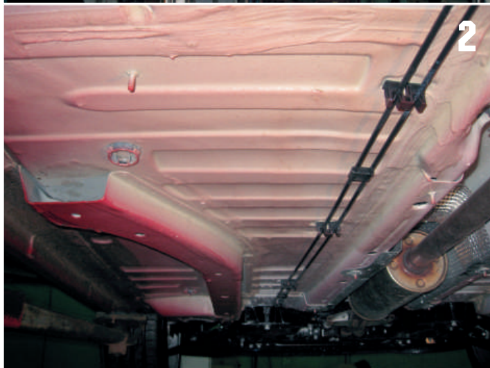
Peugeot 207 выпуска 2007 года, Россия. На днище — лишь заводская защита. Долго на российских дорогах она не продержится.
