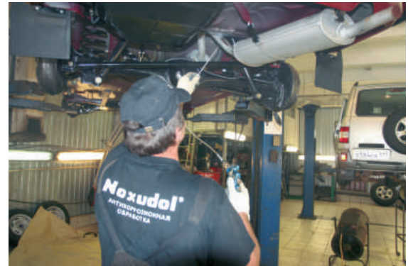
Приемы работы с Mercasol и Noxudol при защите полостей не отличаются друг от друга.
