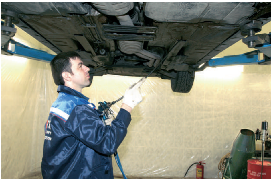
Обработка полостей в положении «с подъемника»
