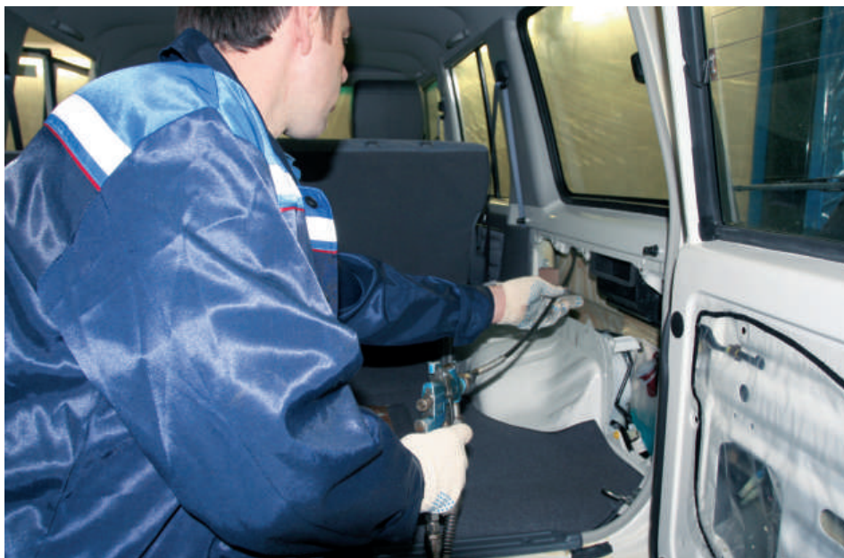
При обработке панели салона частично демонтируются
