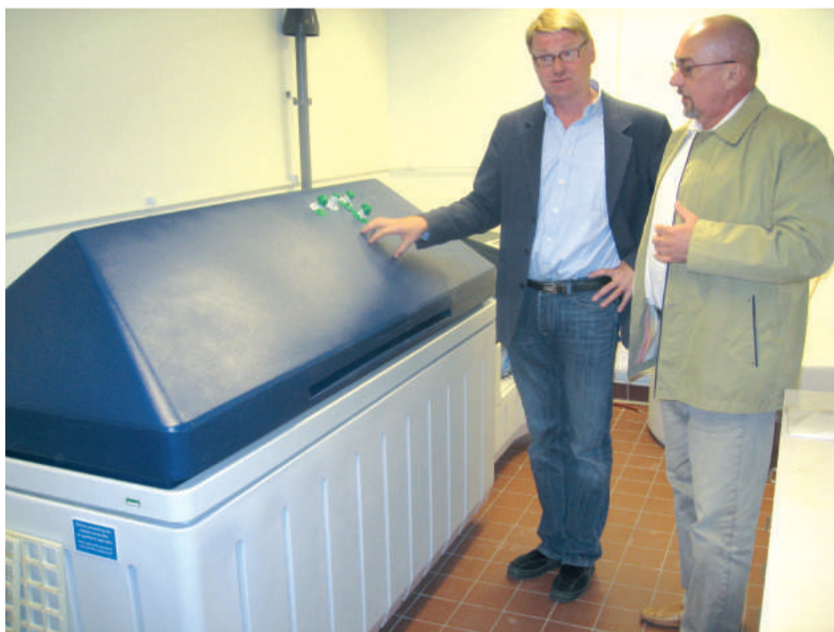
Камера соляного тумана для ускоренных коррозионных испытаний
