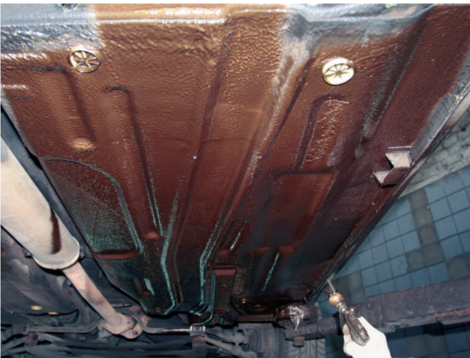
И снова Mercasol. Так выглядит пленка нового препарата для днища, входящего в систему Microshield. Полимер содержит уникальный наполнитель — полимерные микросферы.
