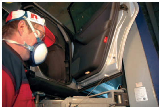
Двери обрабатываются через технологические и дренажные отверстия.
