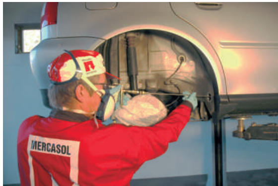
Пороги обрабатываются одинаково: вводится насадка, включается «факел распыления», после чего насадка медленно вытягивается из порога.
