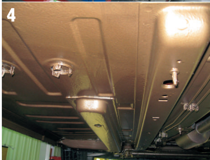
Peugeot 307 выпуска 2007 года, Швеция. Автомобиль обработан по системе Microshield. Сравните символическую заводскую защиту на фото 2 и мощный золотистый слой Microshield на фото 4.
