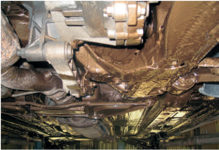
Применяемые материалы — Mercasol, в том числе и входящие в новейшую систему Microshield. Здесь показан промежуточный этап обработки: днище постепенно покрывают золотистой пленкой.
