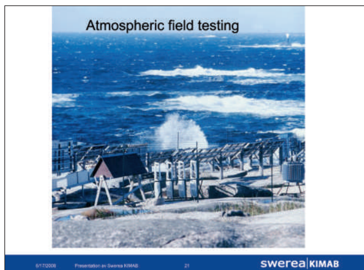
Лаборатория под открытым небом на берегу моря. Эти металлические пластины расскажут о многом.
