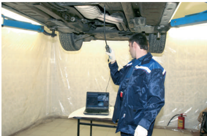
Диагностика полостей кузова бороскопом
