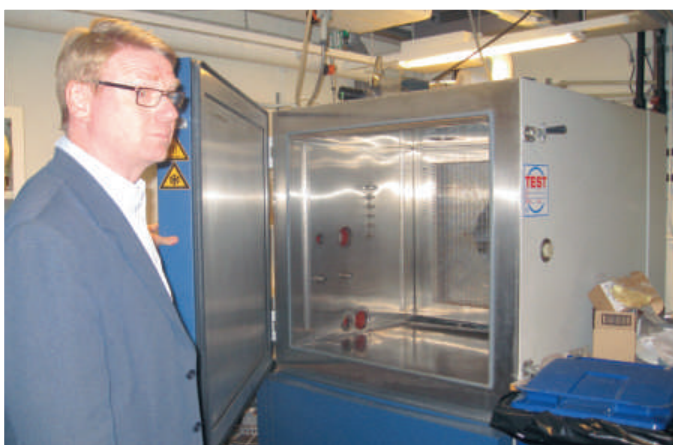
Климатическая камера для ускоренных коррозионных испытаний
