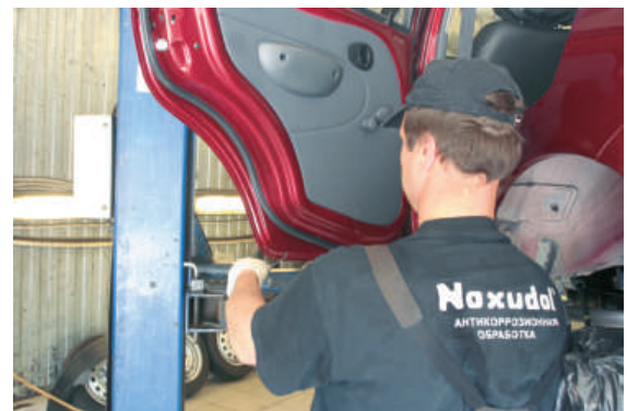
Двери обрабатываются через технологические и дренажные отверстия.
