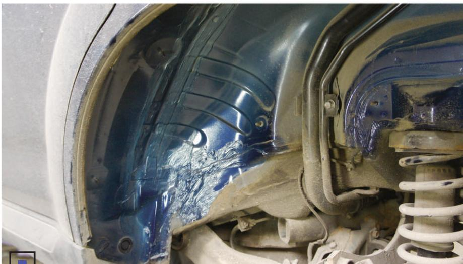
□ Арка автомобиля до обработки (подкрылок снят). Перед нами просто краска...
