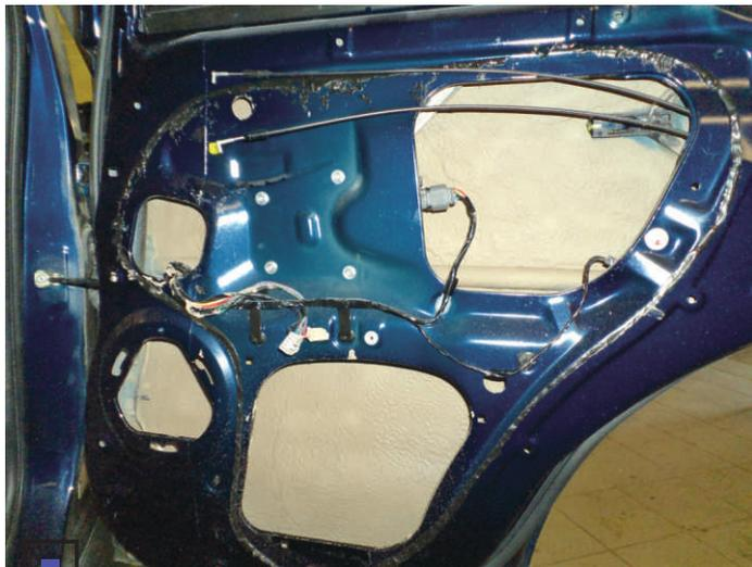
Защита наносилась на внутренние поверхности дверных панелей...
